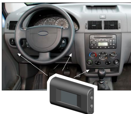
Типичное расположение преобразователя с индикатором (может также быть закреплен на горизонтальной поверхности с помощью крепежного уголка из комплектации)
